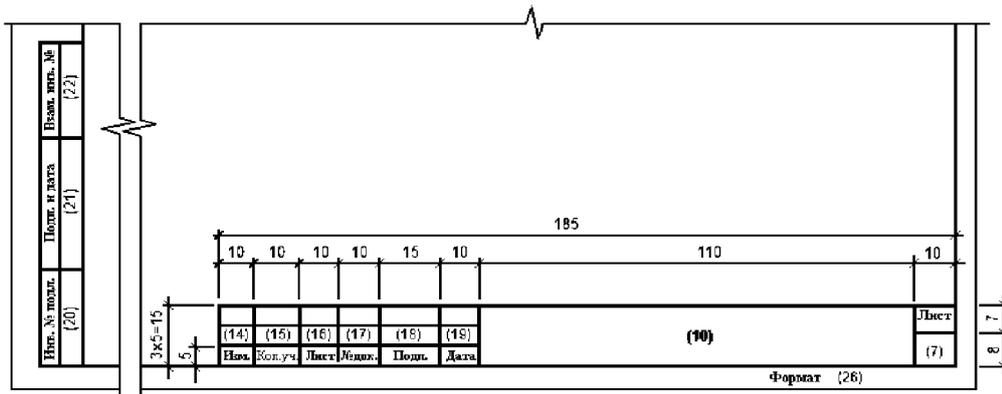
П р и м е ч а н и е – Основную надпись по форме 6 допускается использовать для графических документов по инженерным изысканиям, не используемых в качестве подосновы, а также для последующих листов кабельных и кабельно-трубных журналов при выпуске соответствующих основных комплектов отдельными документами.
