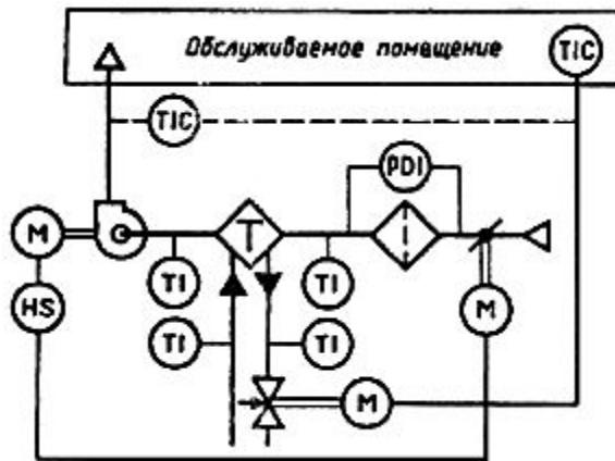
Примечание - Буквенные обозначения измеряемых величин и функциональных признаков приборов, указанные на схеме и в таблице, принятые по ГОСТ 21.404.
